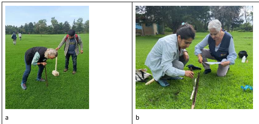
Figura 10.- Barrenación de suelos en Vivero Alto, Ciudad Universitaria.
