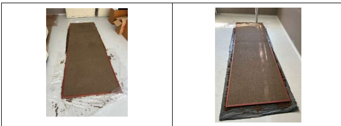
Figura 4. Elaboración de las superficies de resina para la mesa de trabajo del área general.
